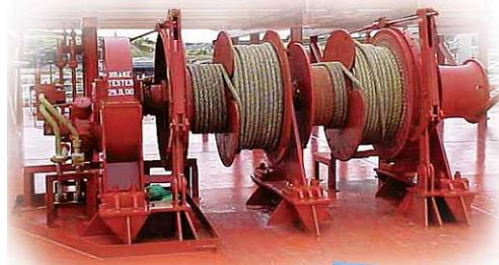
Hình 3. Tời dây tàu thủy với một động cơ lai nhiều trống tời
