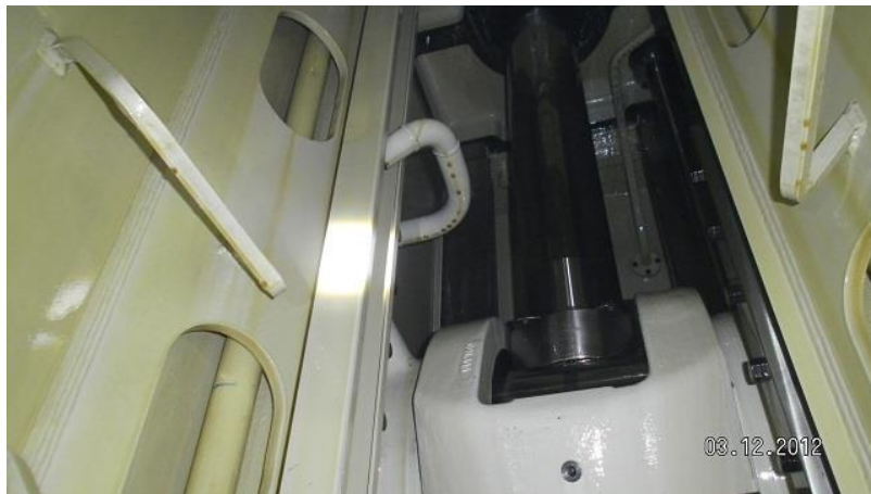
Hình 1: Khoang các-te số 2 có đoạn ống gãy
