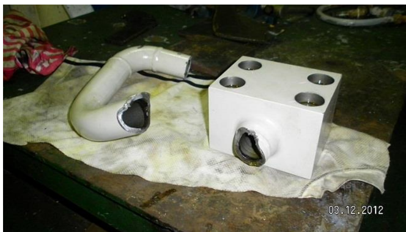
Hình 2: Đoạn ống thoát dầu làm mát đỉnh piston bị gãy
