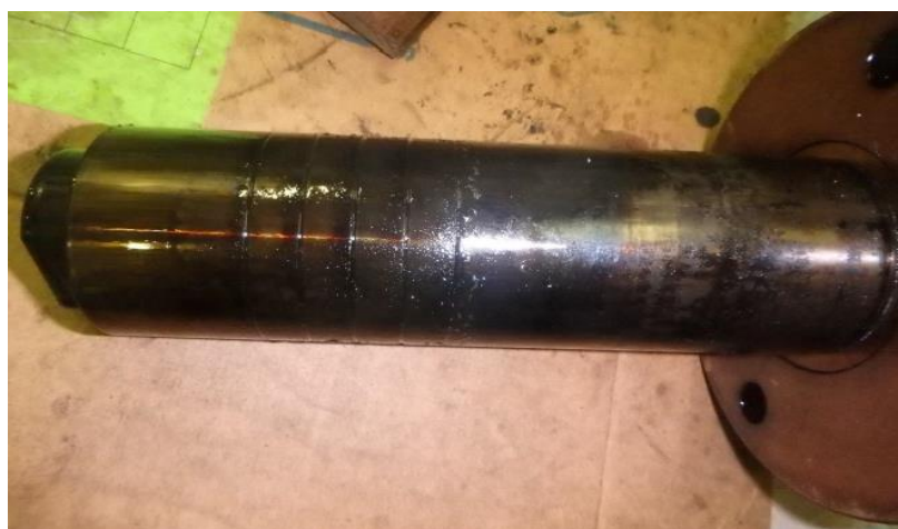
Hình 3: Tình trạng plunger khi được tháo ra
